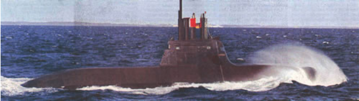
Technologische Meisterleistung - aber auch kein Garant für Vollbeschäftigung: der Brennstoffzellen-U-Boot-Typ 212 von HDW. Foto Behling
